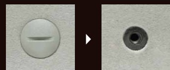
ラゲッジユーティリティナット： ナットの規格サイズ M6
